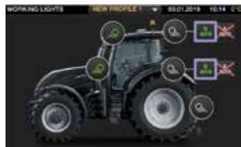
Il est facile de configurer les phares de travail à l'aide de l'écran tactile de 9 pouces. Il existe également des boutons on/off pour les phares de travail et le voyant lumineux de ces derniers se trouve sur l'accoudoir.
