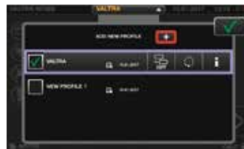
Profils pour les opérateurs et les outils peuvent être facilement modifiés à partir de n'importe quel menu d'écran. Tous les changements de réglages sont sauvegardés dans le profil sélectionné.
